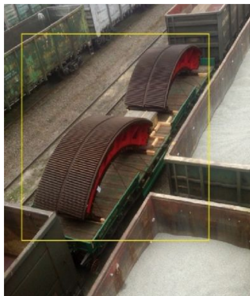
Рис. 1. Приводное зубчатое колесо в разборе на ЖДВ г. Белгород
